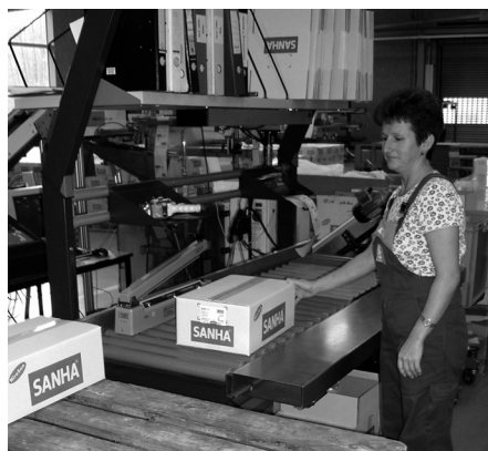
Obrázek 10: Prevence činnosti zvedání a přenášení prostřednictvím výškově nastavitelné pracovní roviny stolů a válečkových dopravníků
