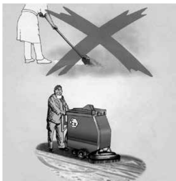
Obr. 3: Nevhodný a vhodný způsob odstranění hořlavého prachu
