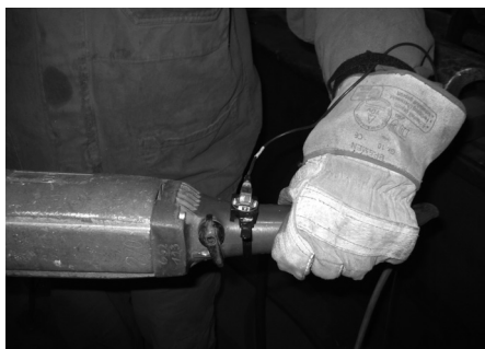
Obr. 1: Měření vibrací rukou a paží
