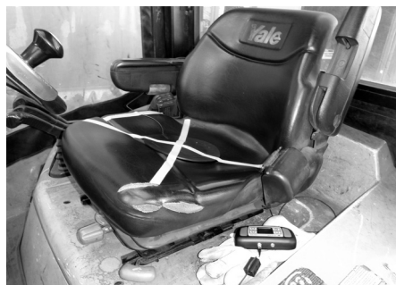
Obr. 2: Měření vibrací celého těla
